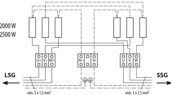
SSG - Saunasteuergerät, LSG - Leistungsschaltgerät
