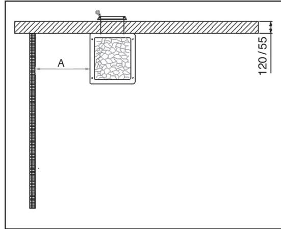
Размер «А» определяется, исходя из вида изоляции деревянной поверхности.
